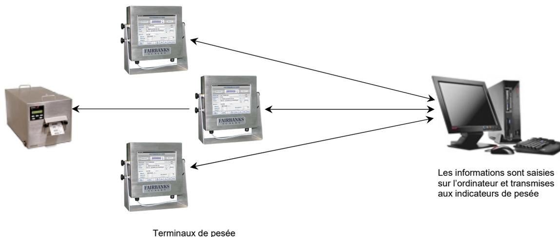
Les pesées effectuées sur chacun des terminaux sont automatiquement transférées à l'ordinateur principal au fur et à mesure qu'elles sont effectuées et que les étiquettes sont imprimées. Il est ainsi possible de suivre la production en temps réel à partir de l'ordinateur principal.
